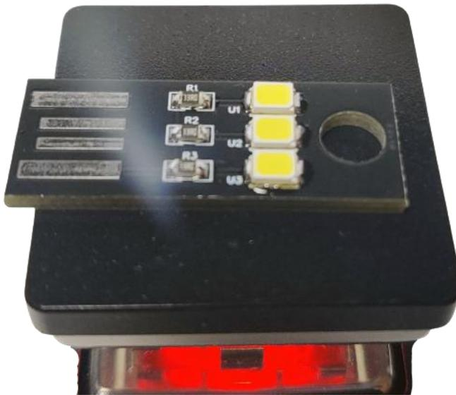
Lorsque la température dépasse les 200 °c, on observe le changement d'état de la brasure (liquide pour le métal d'apport et gazeux pour les vapeurs d'eau).
