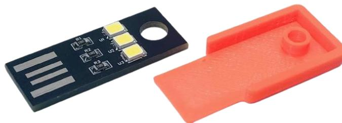
Insérer le PCB dans la coque imprimée
