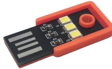
Déposer la résine UV sur les composants en faisant attention à ne pas en mettre sur le port USB. Eviter les bulles qui exploseront durant la polymérisation.
